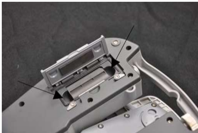
Малюнок 1.29. Відсік для акумуляторної батареї з виїмками (показано стрілками) для полегшення заміни батареї.
