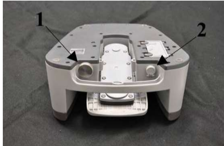
Малюнок 1.30 Первинний (інтегрований) ножний привід (вид ззаду).
