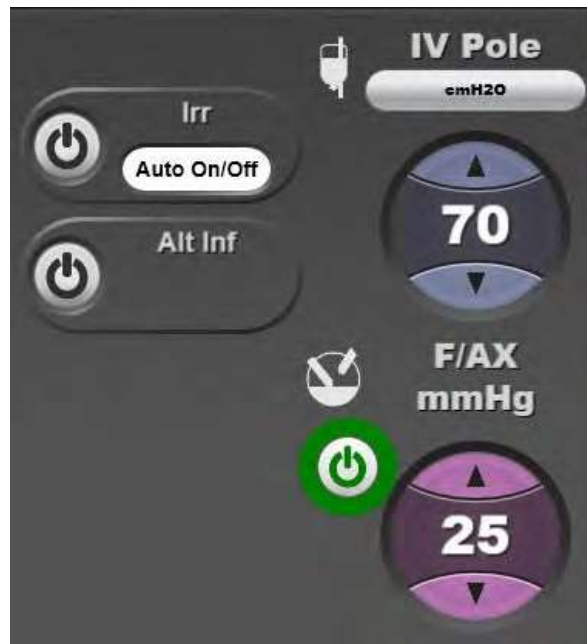
Малюнок 4.14. Зелене кільце навколо кнопки вмикання «On/Off» означає, що насос увімкнено.
