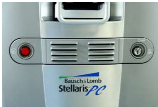
Малюнок 1.50 Передня панель з кнопкою аварійної зупинки лазера, вентиляційними отворами та ключовим перемикачем.
