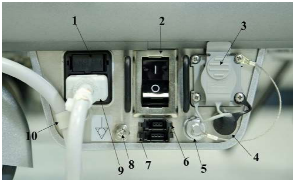
Малюнок 1.58 Порт з'єднання простору (7) та порт з'єднання фільтра мікроскопа (6).
