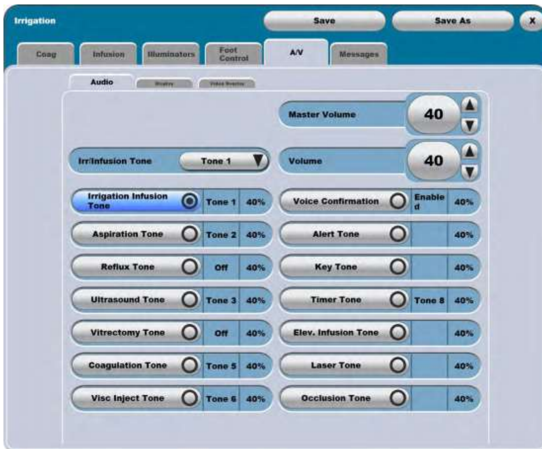
Малюнок 2.22. Вкладка «A/V» («Аудіо/Відео»), підвкладка «Audio» («Аудіо») на додатковому екрані.
