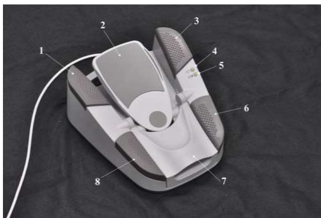
Малюнок 1.38 Первинний (інтегрований) ножний привод (з позначками).
