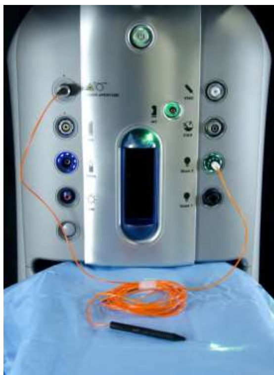
Малюнок 1.51. Лазерний наконечник (зліва) і ЛНО (справа), під'єднані до системи.
