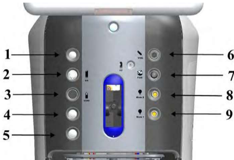
Малюнок 1.24 Передня панель з конекторами наконечників.
