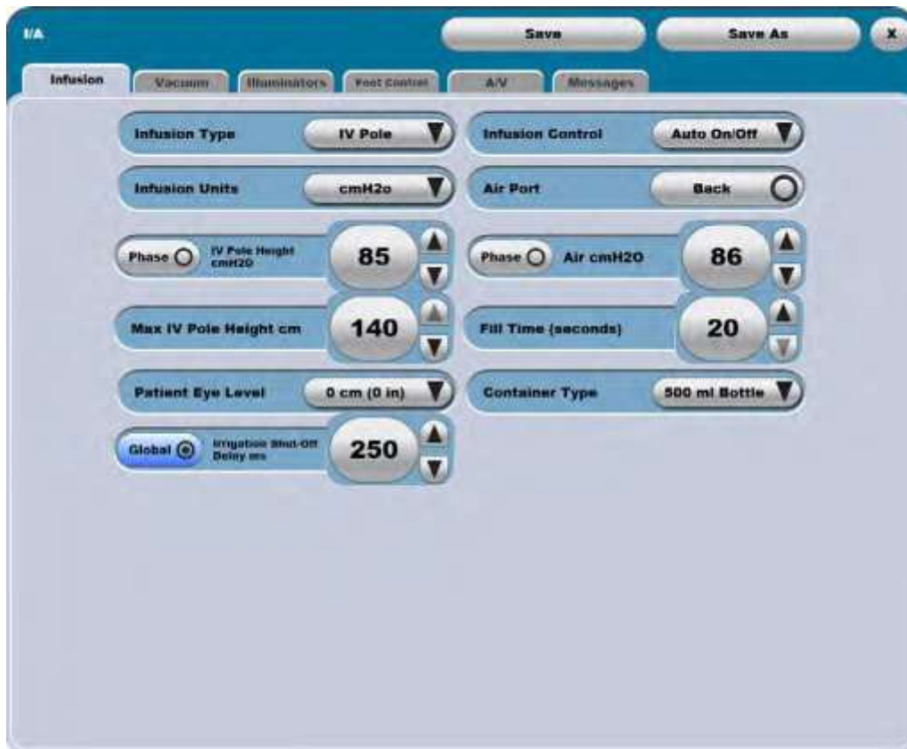
Малюнок 4.27. Додатковий екран, вкладка «Infusion» («Інфузія») (режим операцій у передній частині).
