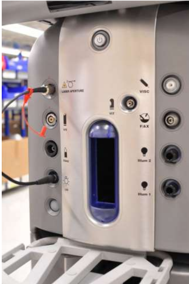
Малюнок 1.57 Система з підключеним лазерним непрямим офтальмоскопом (ЛНО).
