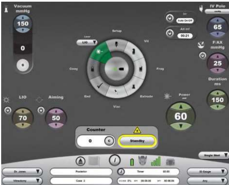
Малюнок 1.59 Хірургічний екран, на якому вибрано підкржжм LIO і лазер знаходиться у стані очікування.
