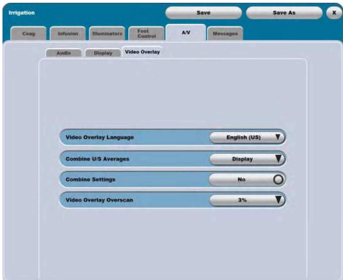
Малюнок 2.24. Вкладка «A/V» («Аудіо/Відео»), підвкладка «Video Overlay» («Накладання зображень») на додатковому екрані.
