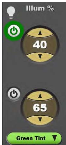
Малюнок 4.8. Навколо кнопки вмикання/вимикання (On/Off) відображено зелене кільце, це означає, що нижній порт освітлення (з правої сторони) увімкнено.
